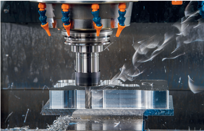
Imco bietet Fräser mit bis zu 13 Schneiden: Großen Wert legt der Hersteller auf die Qualität der Schneidkanten. (© Imco)
